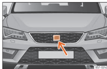
Fig. 260 En el frontal tras el emblema de SEAT: sensor de radar.
