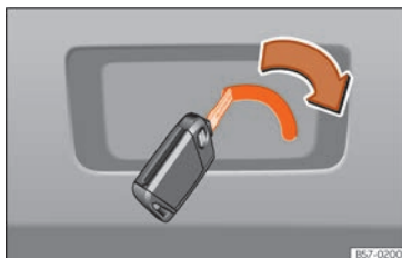
Fig. 11 Detalle del maletero: desbloqueo de emergencia.
