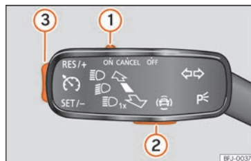
Fig. 54 A la izquierda de la columna de la dirección: conmutador y mandos de manejo del GRA.
