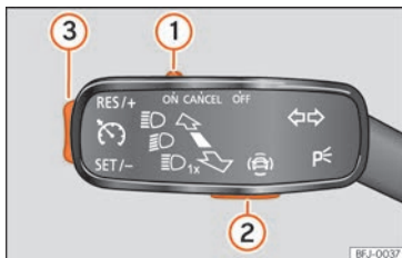
Fig. 252 A la izquierda de la columna de la dirección: mando y teclas para manejar el limitador de velocidad.
