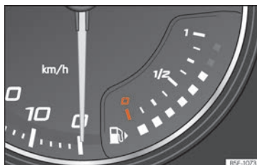
Fig. 128 Cuadro de instrumentos analógico: indicador de nivel de combustible
