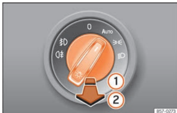
Fig. 152 Tablero de instrumentos: mando de las luces.
