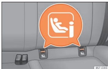
Fig. 39 Anillas de sujeción ISOFIX/i-Size.
