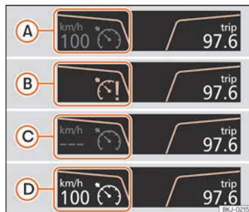
Fig. 250 Pantalla del cuadro de instrumentos: indicaciones de estado del GRA.
