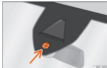
Fig. 186 Sensor de humedad y temperatura del parabrisas.
