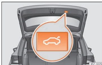
Fig. 145 Portón trasero abierto: tecla para cerrar el portón inmediatamente.
