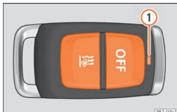
Fig. 187 Calefacción independiente: mando a distancia por radiofrecuencia.
