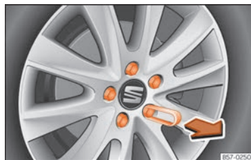
Fig. 75 Rueda: tornillos de la rueda con capuchones.
